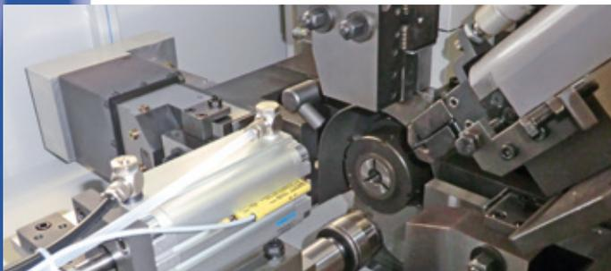
Die Maschinenreihe AUDREMA<sup>®</sup> tc10 greift auf das bewährte modulare System der Reihe tm10 zurück und ergänzt dieses durch neue CNC-gesteuerte Werkzeugträger.
